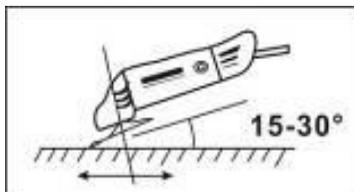
Mantener firmemente la empuñadura (3) y la empuñadura principal (6) y encender la herramienta. Evitar bloquear las ranuras de ventilación con la mano, dado que esto puede hacer que la amoladora se sobrecaliente. Dejar que el disco alcance su plena velocidad. Aplicar la amoladora sobre el elemento que se desea amolar. El efecto máximo se obtiene cuando se mantiene la amoladora en un
